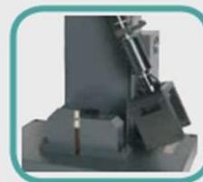
悬臂梁冲击满足标准 ASTM E23 中悬臂梁部分和国标 JIG 609
