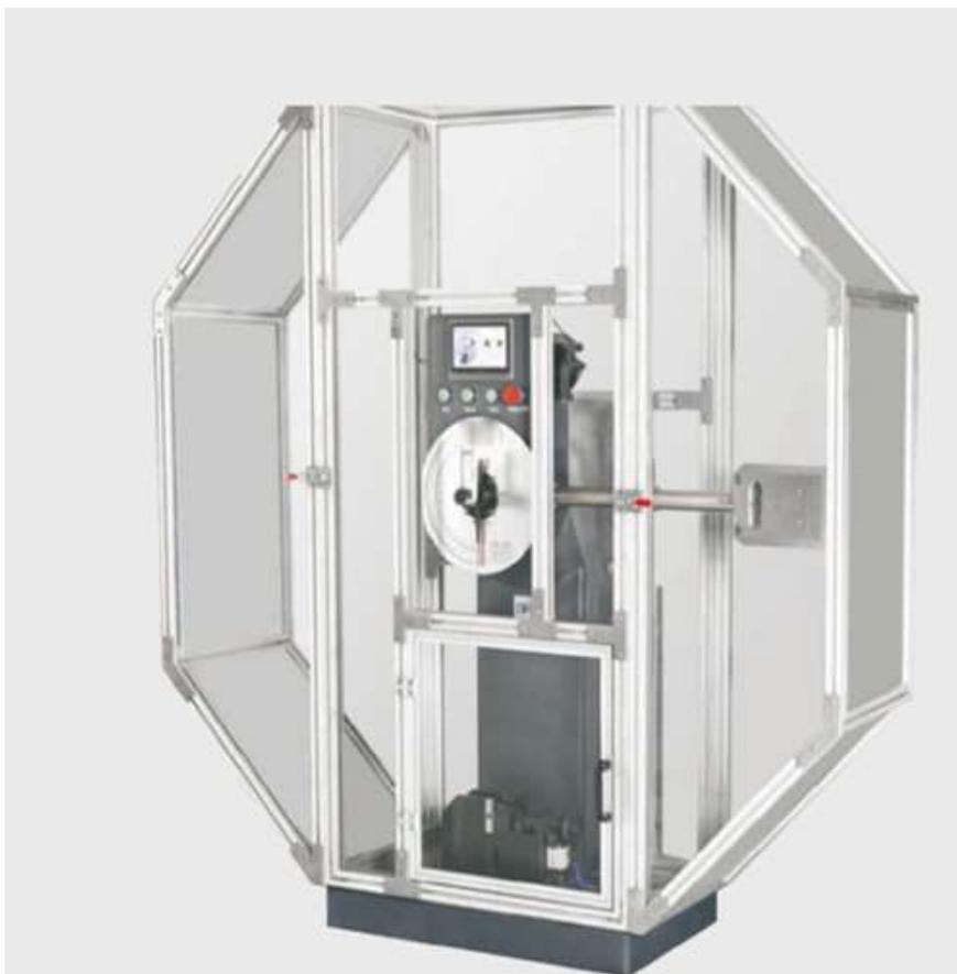
U型摆体结构，可通过更换不同的冲击支架和冲击刀刃实现：夏比/艾氏一体化支座、高速拉伸冲击支座，实现夏比（Charpy）冲击、艾氏（Izod）冲击、高速拉伸冲击等多种实验方法
